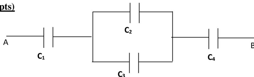
1- La différence de potentiel aux bornes de chaque condensateur (avec  $u_{AB}=16V$ ,  $C_1=2 \mu F$ ,  $C_2=3 \mu F$ ,  $C_3=7 \mu F$  et  $C_4=5 \mu F$ ). (02 pts)
