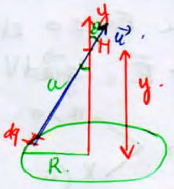
à cause de la symétrie suivant (Oy) ; le champ électrique a une seule composante suivant (Oy) : ( $E_x = 0$  et  $\vec{E} = E_y \vec{j}$ ).
