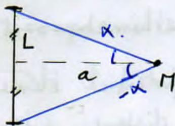
$$\vec{E} = \frac{2k\lambda}{a} \sin\alpha \vec{i} \quad \text{avec} \quad \sin\alpha = \frac{L}{\sqrt{L^2 + a^2}}$$
